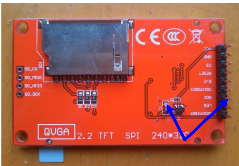
彩屏实物管脚图，LED 管脚与箭头处短接，否则背光不亮，看不到显示。
